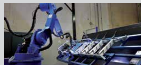
Soudure robotisée pour un cordon toujours identique.
