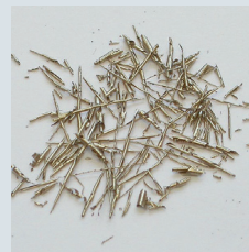
Copeaux réalisés avec une lime Multifile (échelle x 2,7)
